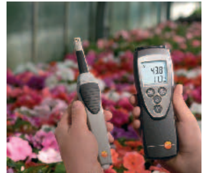
Feuchte-Fühlerkopf gesteckt auf Funkhandgriff, z.B. zur Kontrolle der Klimasteuerung
