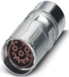
Kabelsteckverbinder, gerade, SPEEDCON-Verriegelung, M17, Polzahl: 17, Kontaktart: Buchse, Crimpanschluss, geschirmt: ja, Kabeldurchmesser: 9 mm...11 mm
