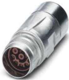
Kupplungssteckverbinder, gerade, SPEEDCON-Verriegelung, M17, Polzahl: 8, Kontaktart: Buchse, Crimpanschluss, geschirmt: ja, Kabeldurchmesser: 3,5 mm...5,5 mm
