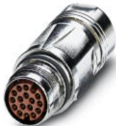
Spojkový konektor, přímý, Zajištění SPEEDCON, M17, Počet pólů: 8, Druh kontaktu: Kolík, Lisovaný spoj, stíněná: ano, Průměr kabelu: 8 mm...10 mm
