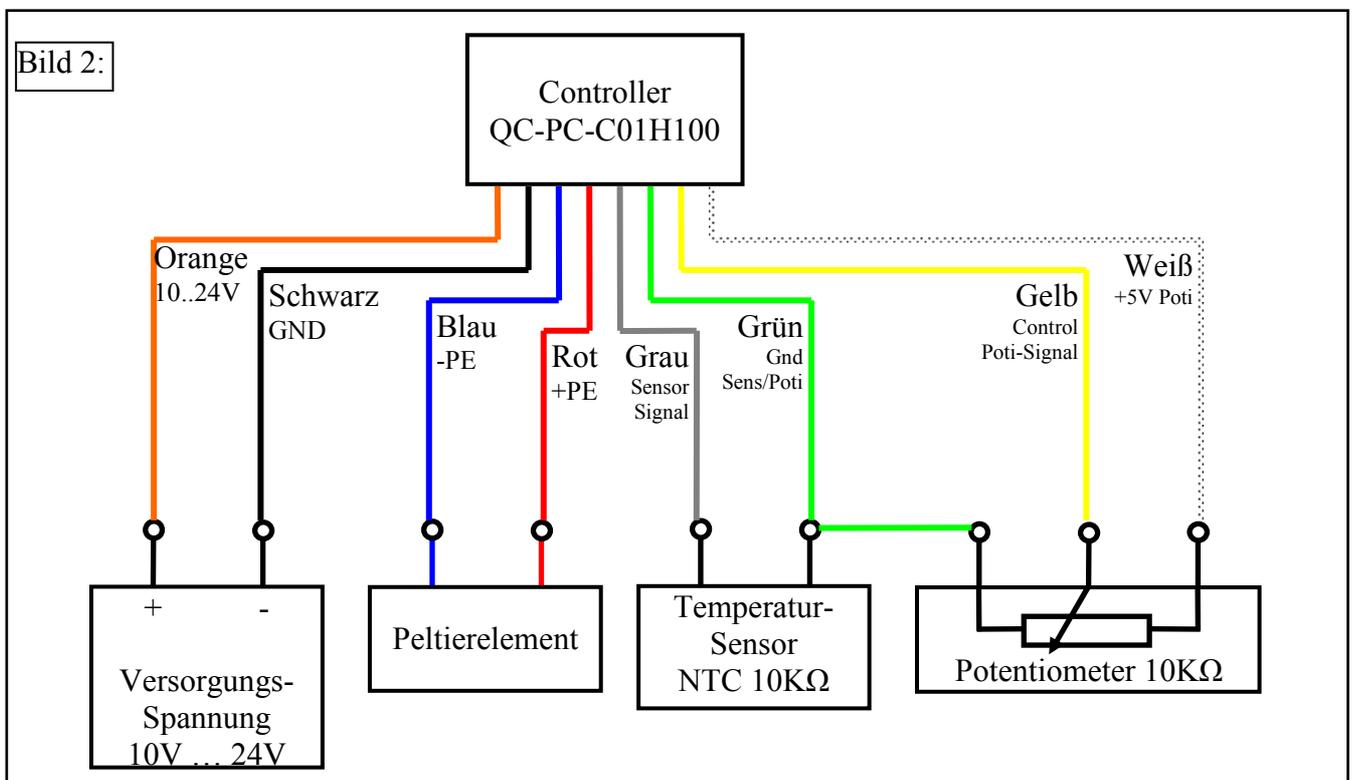
Wenn Sie sich nach diesem Schaltplan richten und Peltierelemente aus dem Hause QUICK-OHM verwenden, dann wird die bedruckte Seite kalt und die blanko Seite warm.
