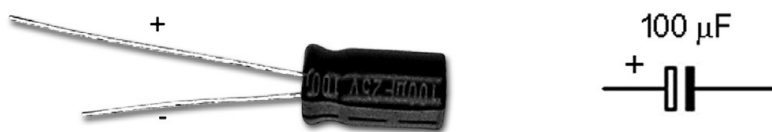
Skica 11: Elektrolitski kondenzator
