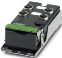
AS-i-Digital Ein-/ Ausgabegerät, AB-Slave, 2 digitale Eingänge, 24 V DC, 2-, 3- und 4-Leiter-Anschluss-technik, 2 digitale Ausgänge, 24 V DC Schutzart IP67
