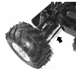
Šipka označující tyč se závitů k seřízení sbíhavosti přesních kol
