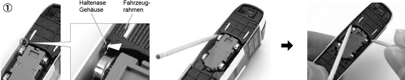
Um das Gehäuse abzunehmen drehen Sie das Modell vorsichtig auf den Rücken. Mit Hilfe eines Zahnstochers oder eines ähnlichen Werkzeuges lösen Sie die Halterung neben den Drehgestellen indem Sie das Gehäuse leicht nach außen drücken. Zugleich heben Sie mit einem zweiten Zahnstocher das Chassis an. Das Gehäuse löst sich nun komplett und kann vollständig abgenommen werden. Verfahren Sie auf die gleiche Art und Weise auch mit der gegenüberliegenden Seite (dem zweiten Drehgestell).
