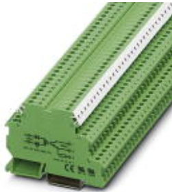
Eingabe-Solid-State-Relaisklemme, Eingang: 12 V DC, Ausgang: 3 - 48 V DC/100 mA, Klemmenbreite 6,2 mm
