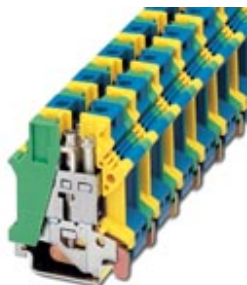
Schutzleiter-Reihenklemme, Anschlussart: Schraubanschluss, Querschnitt: 2,5 mm 2 - 25 mm 2 , AWG: 12 - 4, Breite: 24,4 mm, Farbe: grün-gelb-blau, Montageart: NS 35/7,5, NS 35/15, NS 32
