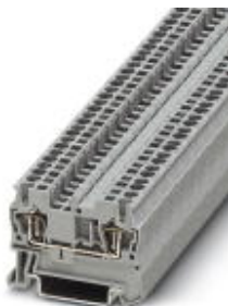
Durchgangsreihenklemme, Anschlussart: Zugfederanschluss, Querschnitt: 0,08 mm 2 - 4 mm 2 , AWG 28 - 12, Breite: 5,2 mm, Farbe: braun, Montageart: NS 35/7,5, NS 35/15
