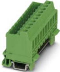
Steckerteil, Nennstrom: 12 A, Bemessungsspannung (III/2): 320 V, Polzahl: 13, Rastermaß: 5,08 mm, Anschlussart: Schraubanschluss, Farbe: grün, Kontaktoberfläche: Zinn, Montage: Tragschiene
