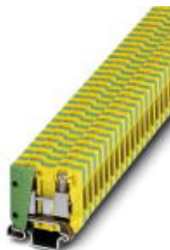
Schutzleiter-Reihenklemme, Anschlussart: Schraubanschluss, Querschnitt: 0,2 mm 2 - 2,5 mm 2 , AWG: 24 - 14, Breite: 5,2 mm, Farbe: grün-gelb, Montageart: NS 15
