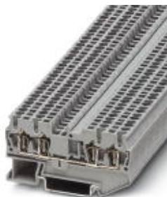
Durchgangsklemme, Anschlussart: Zugfederanschluss, Querschnitt: 0,08 mm 2 - 1,5 mm 2 , AWG: 28 - 16, Breite: 4,2 mm, Farbe: grau, Montageart: NS 35/7,5, NS 35/15
