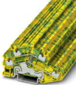
Schutzleiter-Doppelstockklemme, Querschnitt: 0,14 mm 2 - 1,5 mm 2 , AWG: 26 - 14, Anschlussart: Push-in-Anschluss, Breite: 3,5 mm, Farbe: grün-gelb, Montageart: NS 35/7,5, NS 35/15
