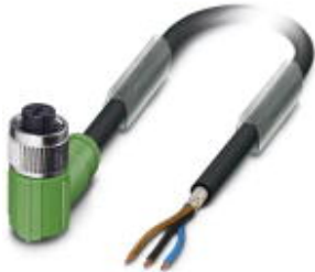
Sensor-/Aktor-Kabel, 3-polig, PUR halogenfrei, schwarzgrau RAL 7021, geschirmt, freies Leitungsende, auf Buchse gewinkelt M12, A-kodiert, Kabellänge: 5 m
