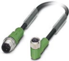
Sensor-/Aktor-Kabel, 3-polig, PUR halogenfrei, schwarzgrau RAL 7021, Stecker gerade M12, A-kodiert, auf Buchse gewinkelt M8, Kabellänge: 0,3 m
