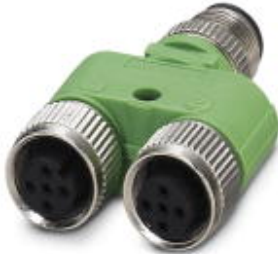
Y-Verteiler, 3-polig + PE, gerader Stecker M12 auf 2 x gerade Buchse M12, Stichmaß 21 mm
