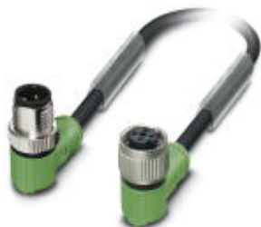
Sensor-/Aktor-Kabel, 4-polig, PUR halogenfrei, schwarzgrau RAL 7021, Stecker gewinkelt M12 SPEEDCON, A-kodiert, auf Buchse gewinkelt M12 SPEEDCON, A-kodiert, Kabellänge: 15 m
