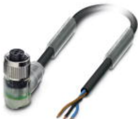
Sensor-/Aktor-Kabel, 3-polig, PVC, schwarz RAL 9005, freies Leitungsende, auf Buchse gewinkelt M12, A-kodiert, mit 2 LEDs, Kabellänge: 8 m
