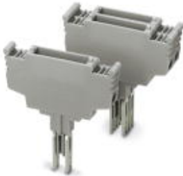
Bauelementestecker mit Leuchtanzeige, zur Einschaltung 2-poliger Bauelemente in die Grundklemme, Höhe: 19 mm, Farbe: grau, Spannung Leuchtanzeige: 24 V DC
