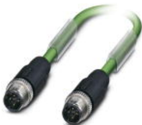
Bussystem-Kabel, PROFINET, PROFINET, 4-polig, PVC, grün RAL 6018, geschirmt, Stecker gerade M12, D-kodiert, auf Stecker gerade M12, D-kodiert, Kabellänge: 5 m
