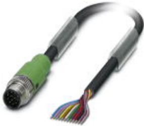
Sensor-/Aktor-Kabel, 12-polig, PUR halogenfrei, schwarz RAL 9005, Stecker gerade M12 SPEEDCON, A-kodiert, auf freies Leitungsende, Kabellänge: 3 m
