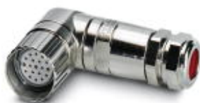
Anschlussbuchse M23, 19-polig, gewinkelt, frei konfigurierbar, mit Lötanschluss, für Leitungsaußendurchmesser 10 mm ... 14 mm
