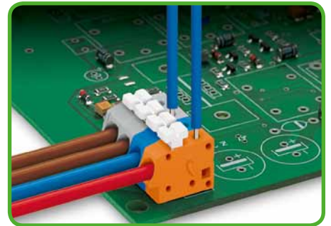
Prüfen - mit Prüfstift Ø 1 mm. Tippkontaktierung von Hand.
