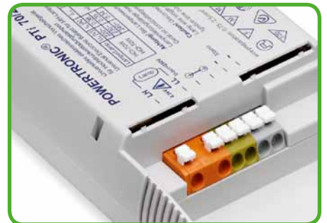
Dem Wunsch, z. B. Schutzleiterverbindungen nicht über die Platine zu führen, trägt WAGO mit der „internen Brückung“ von Klemmenleisten der Serie 804 Rechnung. Hierbei werden werkseitig Klemmenleisten nach Kundenspezifikation miteinander gebrückt und auf Wunsch gekennzeichnet.
