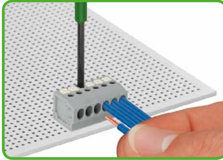
Anschließen eindrätiger Leiter durch direktes Stecken. Leiter lösen und Anschluss feindrätiger Leiter mittels Drückerbetätigung.
