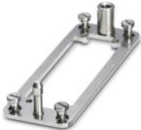
Andockrahmen für Einschübe, für Kontakteinsätze der Bauform B24, mit 4 Flachkopfschrauben M5, Einschubausgleich x/y-Achse +/- 1,5mm
