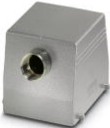
Tüllengehäuse, für Querbügel, Höhe 80 mm, ohne Verschraubung, 1x Pg29, Kabelabgang seitlich
