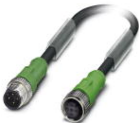
Sensor-/Aktor-Kabel, 4-polig, PUR, schwarzgrau RAL 7021, Stecker gerade M12, A-kodiert, auf Buchse gerade M12, A-kodiert, Kabellänge: 2 m
