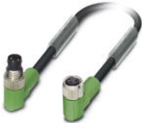
Sensor-/Aktor-Kabel, 3-polig, PUR halogenfrei, schwarzgrau RAL 7021, Stecker gewinkelt M8, auf Buchse gewinkelt M8, Kabellänge: 1,5 m
