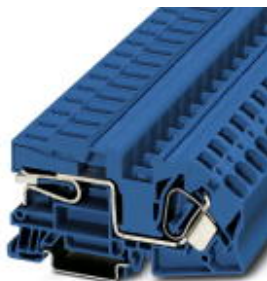
Installationsetagenklemme, Zugfederanschluss, Querschnitt: 0,2 mm 2 - 25 mm 2 , AWG: 24 - 4, Breite: 12 mm, Farbe: blau, Montageart: NS 35/15, NS 35/7,5
