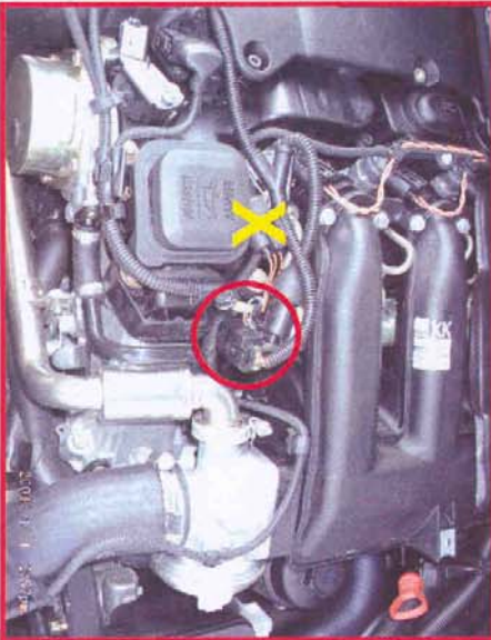
Abb 2: Einbaulage DruckwandlerSENSOR Common Rail Leiste
