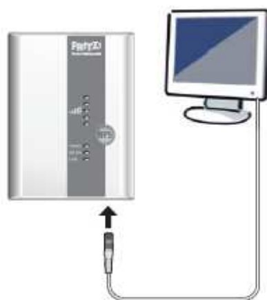
Vključitev naprave preko LAN kabla v domače omrežje
